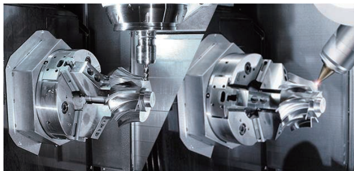
(b) 激光金属沉积与机床(减材制造)集成的多任务加工 [57]
